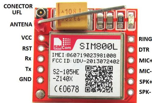
Figura 1. Descripción de los pines del Módulo de GSM/GPRS
